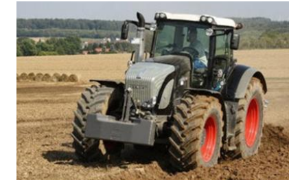
2006 - Fendt vario 936 600/65R34 / 710/70R42 100/80 kPa 261 kW
